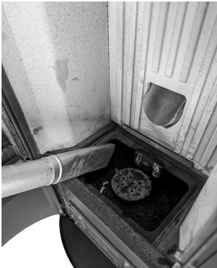
Fig. 38 - Reinigung Fach Brennschale
