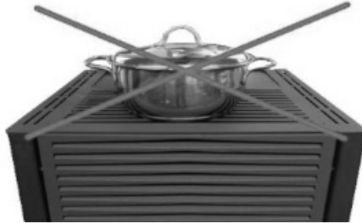
Fig. 27 - Die Lüftungsschlitze nicht verdecken
