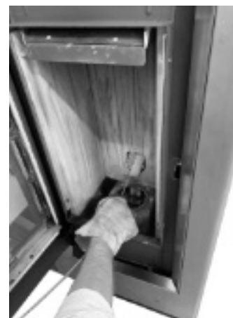
Fig. 35 - Reinigung mit Flaschenbürste
