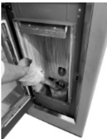
Fig. 34 - Reinigung Fach Brennschale
