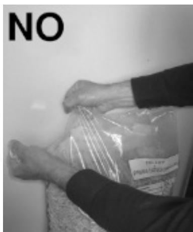
Fig. 22 - Ouverture incorrecte du sac des granulés
