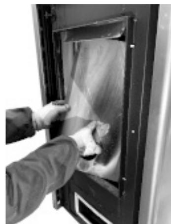
**Fig. 51 - Rimuovere la schiena del focolare**
