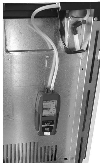
Fig. 37 - Collegamento pressostato digitale
