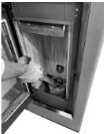
Fig. 34 - Pulizia vano braciere
