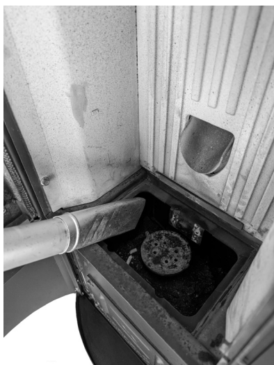
Fig. 38 - Pulizia vano braciere
