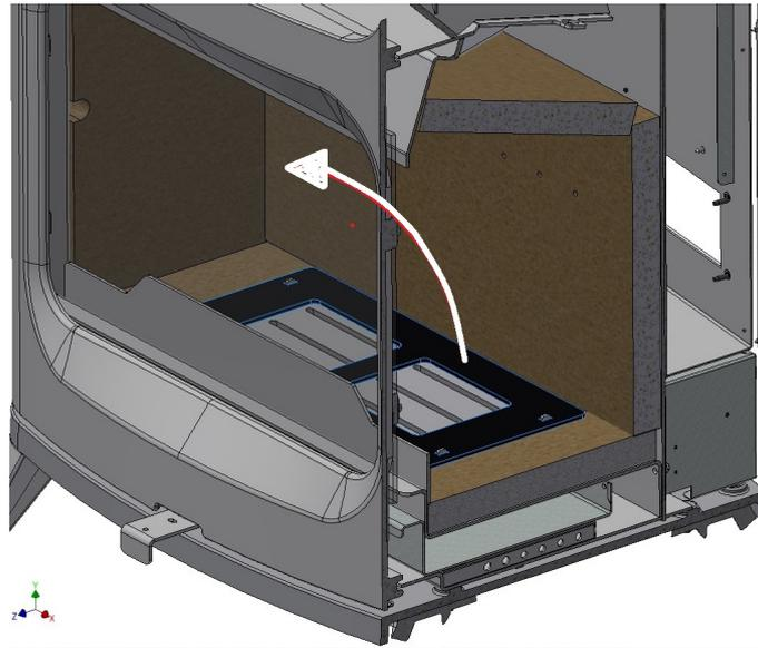
**Fig. 17 - Inneres Reduzierstück entfernen**
