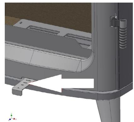
**Fig. 7 - Register öffnen**
