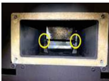
Fig. 65 - Desenrosque los tornillos
