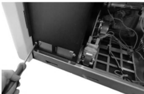
Fig. 68 - Limpieza ventilador ambiente
