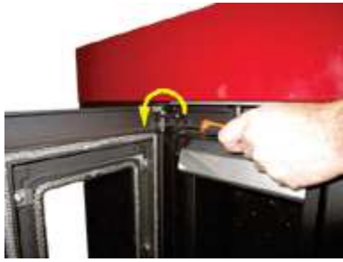
Fig. 15 - Extracción de los tornillos
