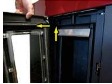
Fig. 16 - Desmontaje de la puerta
