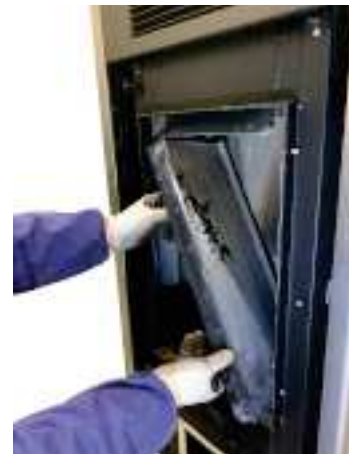
Fig. 61 - Retire las paredes laterales
