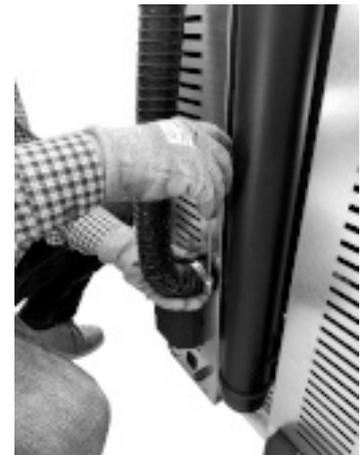
*Fig. 30 - Acople el tubo de aire comburente*
