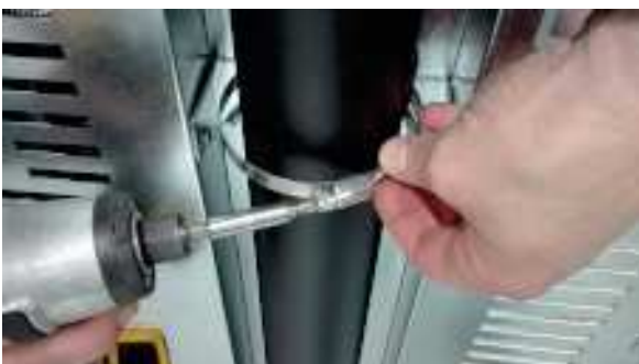
Fig. 31 - Bloquee con la abrazadera
