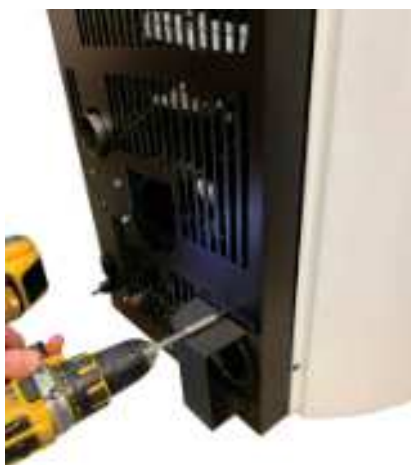
Fig. 36 - Extracción del desviador
