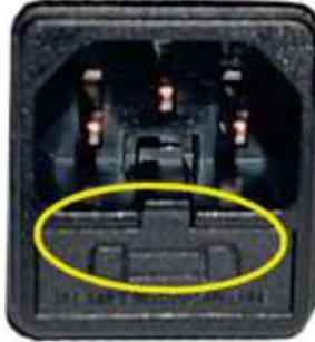
Fig. 70 - Ventanilla con los fusibles de remover
