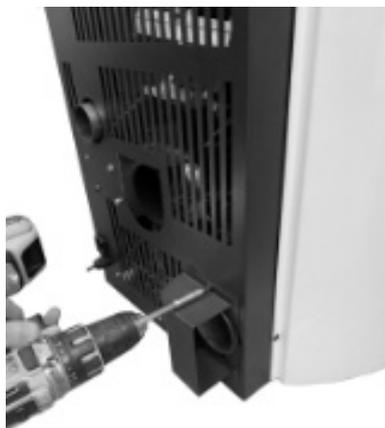
**Fig. 36 - Extracción del desviador**
