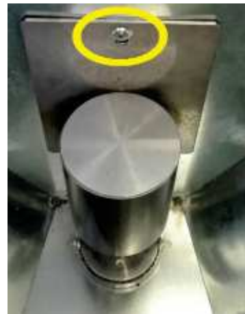
Fig. 72 - Retirada del tornillo
