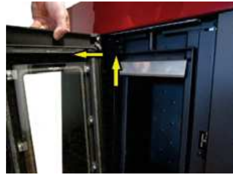
Fig. 14 - Ausbau der Tür
