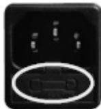
Fig. 68 - Abdeckklappe mit Sicherungen, die ausgewechselt werden müssen
