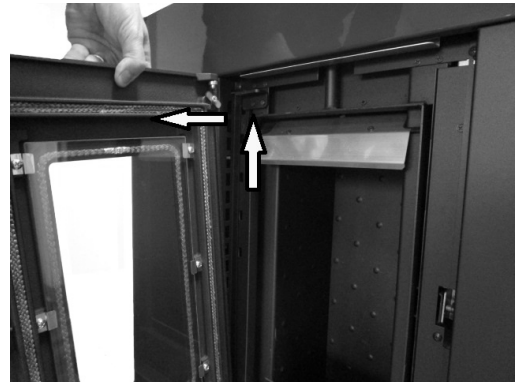
Fig. 14 - Ausbau der Tür
