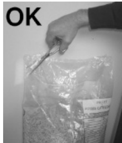
Fig. 22 - Korrekte Öffnung des Pelletsacks
