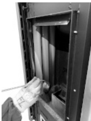
Fig. 69 - Nettoyer avec un goupillon
