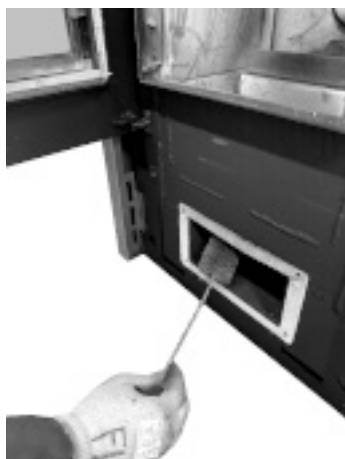
Fig. 61 - Nettoyer avec un goupillon
