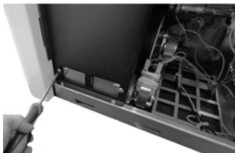
Fig. 75 - Nettoyage de le ventilateur ambiant
