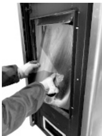
Fig. 67 - Retirer le panneau arrière du foyer
