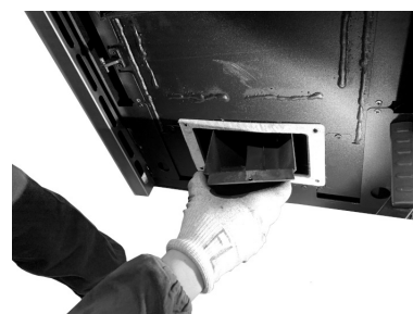
Fig. 73 - Ôter le déviateur de fumées
