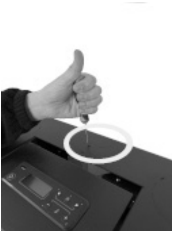
Fig. 29 - Retirer le bouchon
