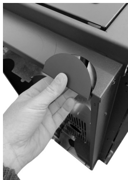
Fig. 35 - Remove the cap
