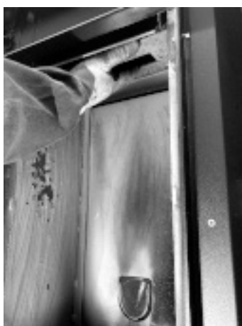
Fig. 56 - Rimuovere la testa del focolare 1
