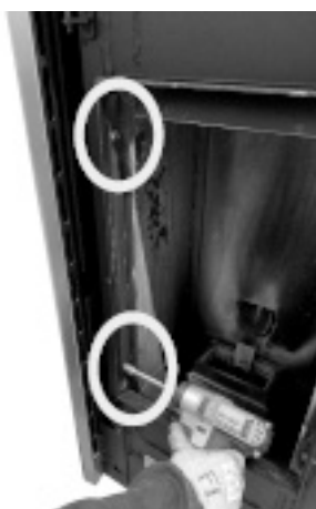
Fig. 55 - Rimuovere viti esagonali
