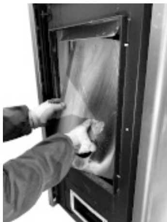
Fig. 58 - Rimuovere la schiena del focolare
