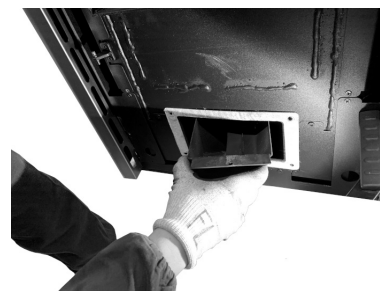
Fig. 64 - Rimuovere il deviatore fumi
