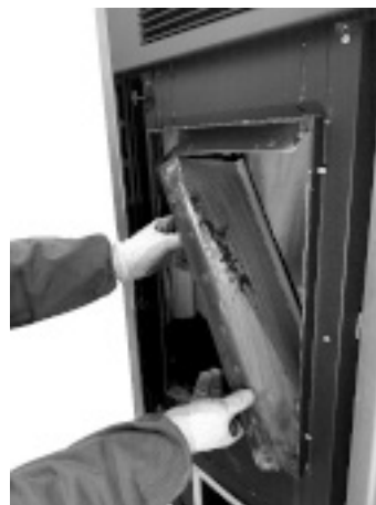
Fig. 59 - Rimuovere le pareti laterali
