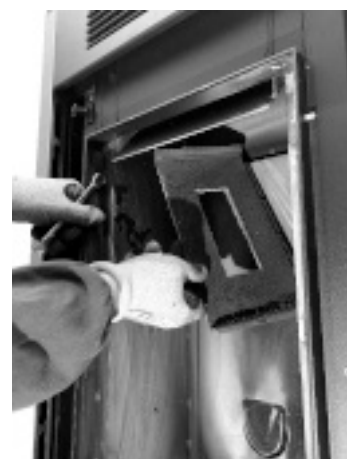
Fig. 57 - Rimuovere la testa del focolare 2
