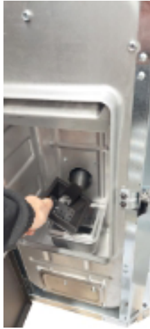
Fig. 39 - Extracción del brasero
