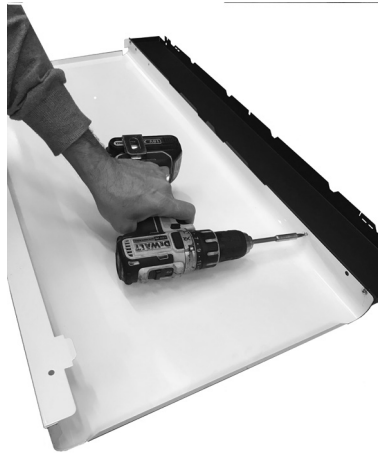
Fig. 39 - Bevestig het gekleurde zijpaneel
