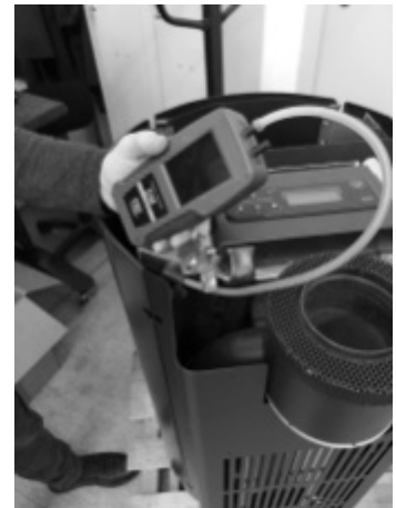
Fig. 68 - Aansluiting digitale drukregelaar 2
