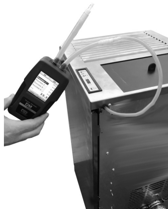
Fig. 67 - Aansluiting digitale drukregelaar 1
