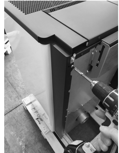
Fig. 40 - Bevestig het volledige zijpaneel
