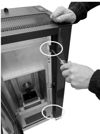
Fig. 35 - De schroeven verwijderen
