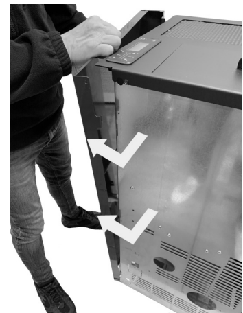
Fig. 37 - De zijpanelen verwijderen
