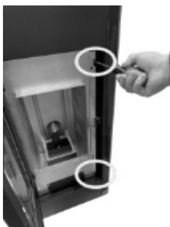
Fig. 44 - De schroeven verwijderen
