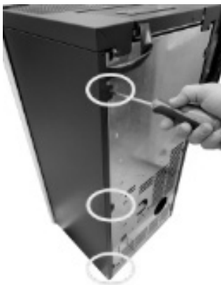
Fig. 32 - De schroeven verwijderen
