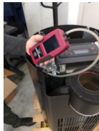
Fig. 74 - Conexión del presostato digital 2
