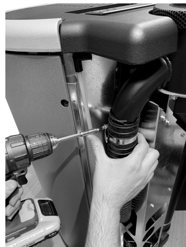
Fig. 60 - Retirar el tubo flexible
