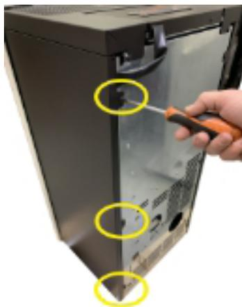
Fig. 35 - Retire los tornillos
