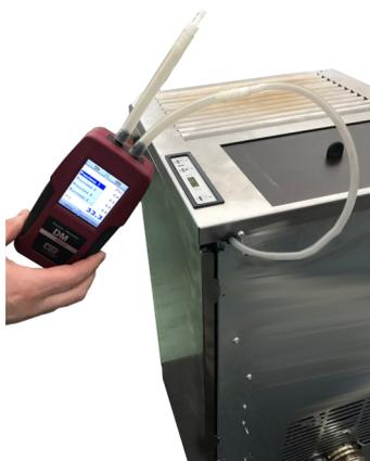
Fig. 73 - Conexión del presostato digital 1
