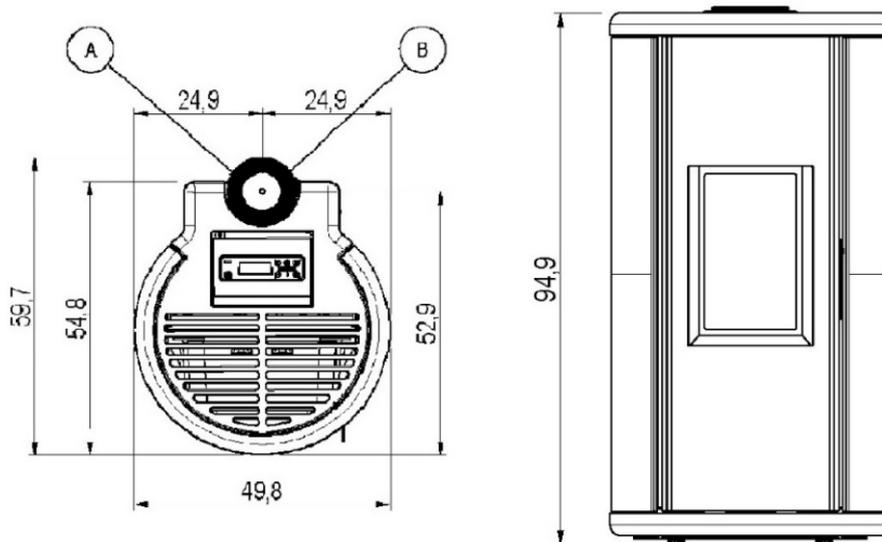
**Fig. 18 - Dimensiones generales: SOUND SUP-Twin - 7UP-Twin**
