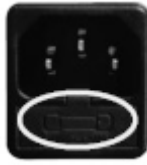
Fig. 82 - Ventanilla con los fusibles de remover
