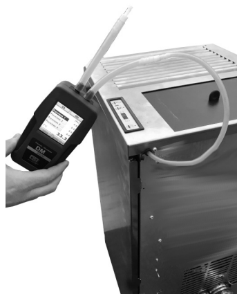
Fig. 69 - Conexión del presostato digital 1
