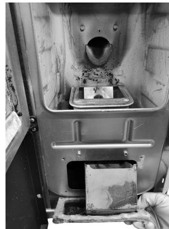
Fig. 76 - Retire la tapa de inspección
