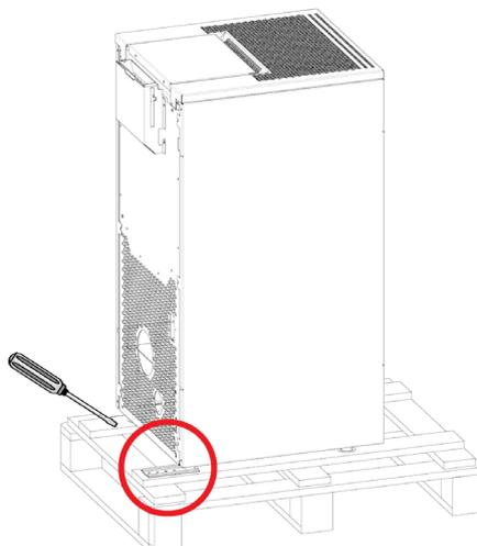
*Fig. 1 - Extracción de las abrazaderas*
