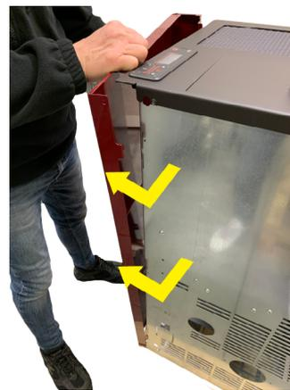
Fig. 43 - Retire las paredes laterales
