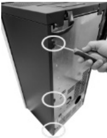
Fig. 34 - Retire los tornillos
