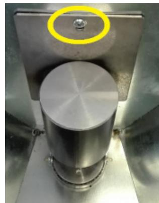
**Fig. 88 - Retirada del tornillo**
