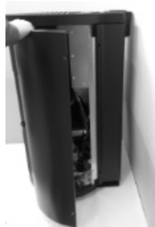
Fig. 50 - Desenganche las paredes laterales
