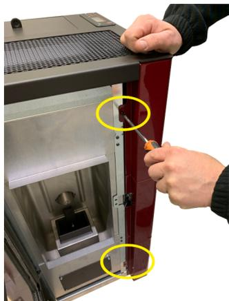
Fig. 41 - Retire los tornillos
