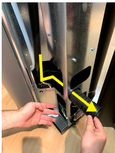
Fig. 65 - Paso del tubo flexible 1
