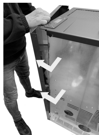
Fig. 39 - Retire las paredes laterales
