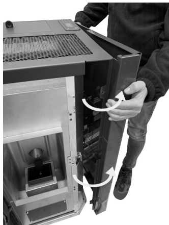
Fig. 38 - Gire las paredes laterales
