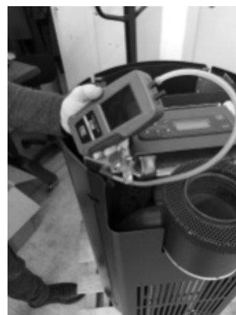
Fig. 70 - Conexión del presostato digital 2
