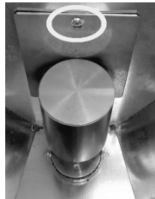
Fig. 84 - Retirada del tornillo
