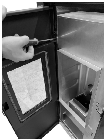
Fig. 28 - Extracción de los tornillos
