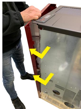
Fig. 48 - Retire las paredes laterales
