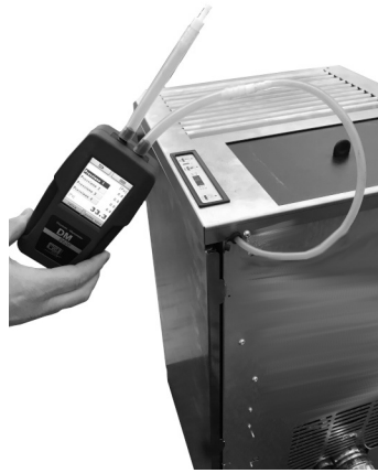
Fig. 67 - Anschluss des Digitaldruckwächters 1
