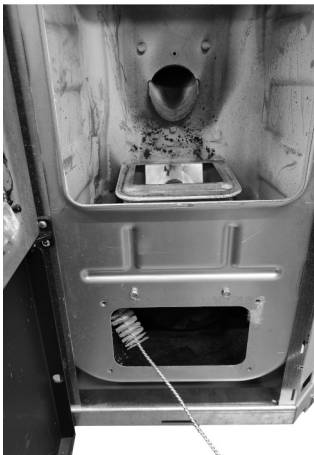
Fig. 75 - Mit einer Rohrreinigungsbürste reinigen
