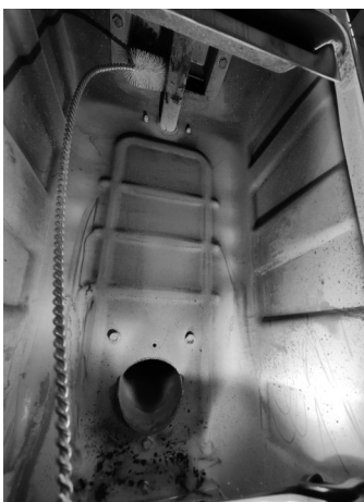
Fig. 77 - Mit einer Rohrreinigungsbürste reinigen
