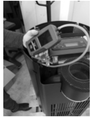
Fig. 68 - Anschluss des Digitaldruckwächters 2
