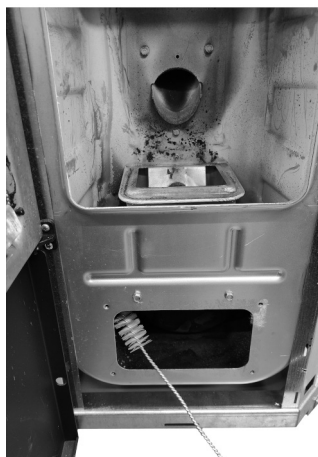
Fig. 84 - Nettoyer avec un goupillon.
