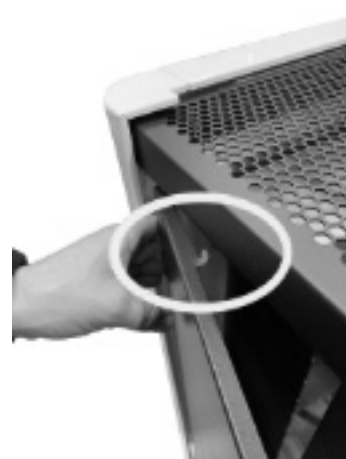
Fig. 43 - Dents de fixation
