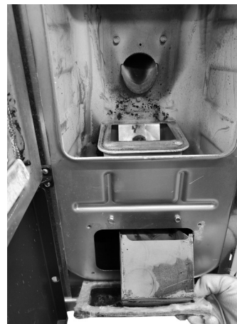
Fig. 83 - Retirer le bouchon d'inspection
