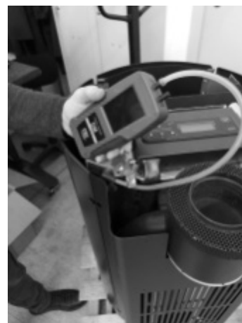
Fig. 77 - Connexion du pressostat numérique 2
