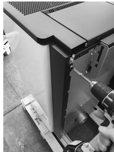
Fig. 49 - Fixer le flanc complet
