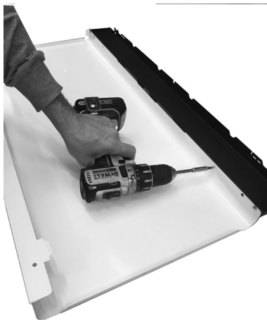
Fig. 48 - Fixer le flanc coloré
