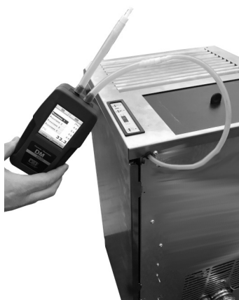
Fig. 76 - Connexion du pressostat numérique 1
