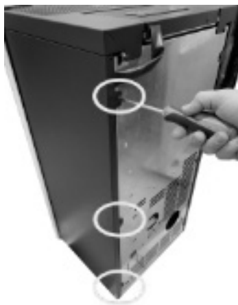
Fig. 41 - Retirer les vis
