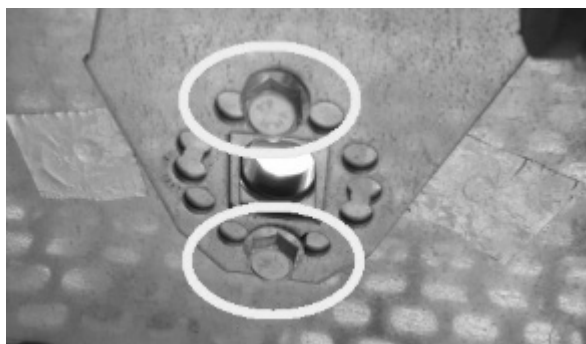
Fig. 90 - Retirer les vis
