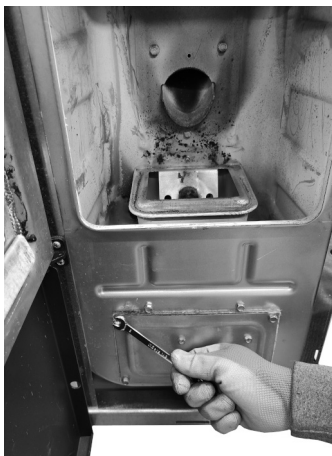
Fig. 82 - Retirer les vis
