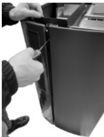
Fig. 50 - Retirer les vis
