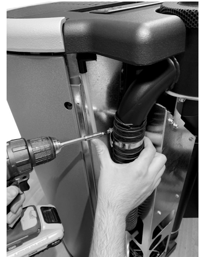
Fig. 67 - Extraire le tuyau flexible
