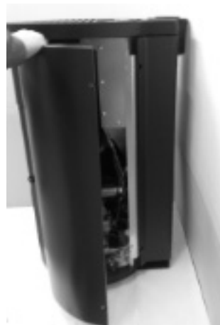
Fig. 57 - Décrocher les flancs
