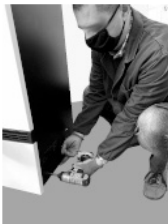
Fig. 65 - Verwijdering van de schroeven
