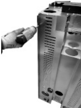
Fig. 29 - Verwijder de schroeven
