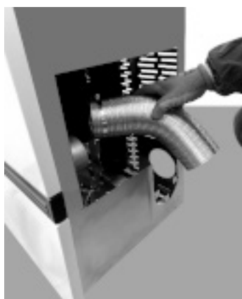
Fig. 97 - Verwijder de flexibele buis
