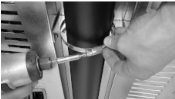
Fig. 76 - Blokkeer met klem
