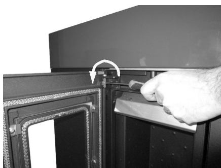
Fig. 19 - Verwijdering van de schroeven
