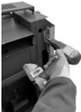
Fig. 33 - Verwijder de schroeven
