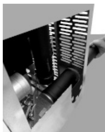
Fig. 98 - Verbind de kanalisatiebuis
