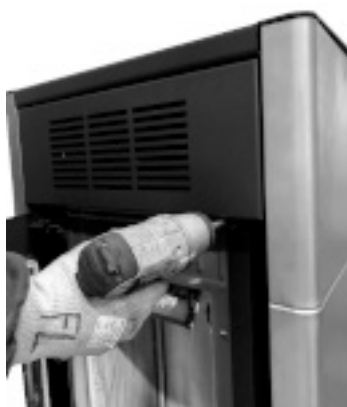
Fig. 24 - Verwijder de schroeven
