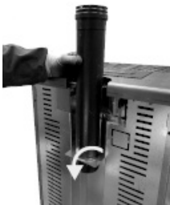
Fig. 70 - Laat de steun zakken
