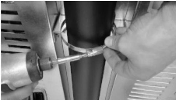
*Fig. 78 - Bloquee con la abrazadera*
