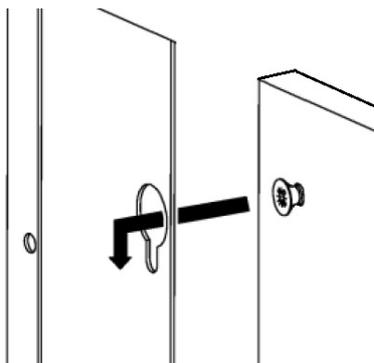
**Fig. 63 - Detalle de cómo se engancha**
