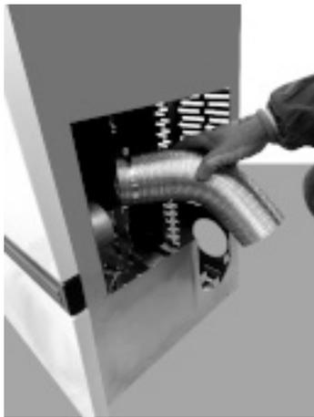
*Fig. 99 - Retire el tubo flexible*
