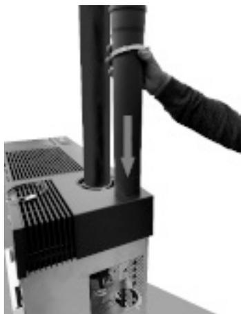
**Fig. 104 - Insertar el tubo de conducción.**
