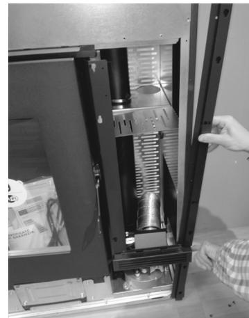
**Fig. 57 - Insertar el montante**
