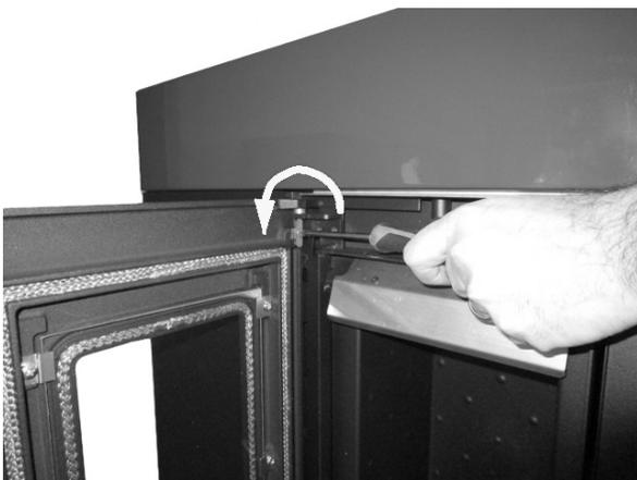
**Fig. 21 - Extracción de los tornillos**
