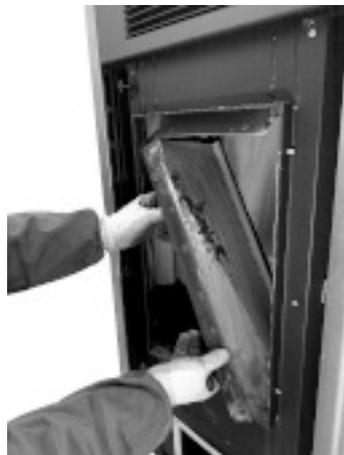
*Fig. 123 - Retire las paredes laterales*
