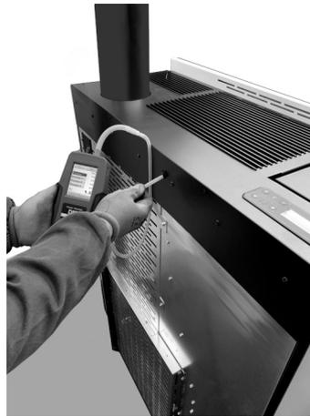
Fig. 111 - Conexión del presostato digital (Mithos)
