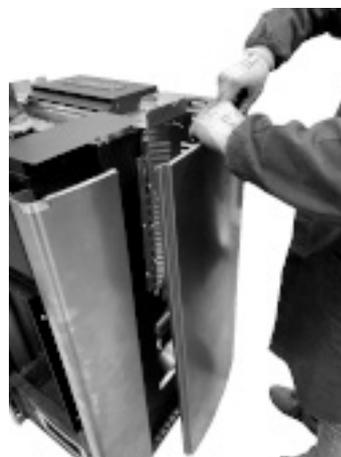
**Fig. 32 - Retire las paredes laterales**
