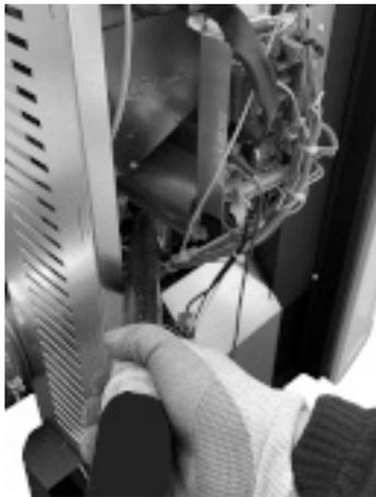
**Fig. 131 - Limpieza ventilador ambiente**
