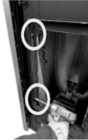
*Fig. 120 - Extraiga los tornillos hexagonales*
