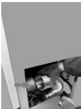
*Fig. 94 - Desconecte el tubo flexible*
