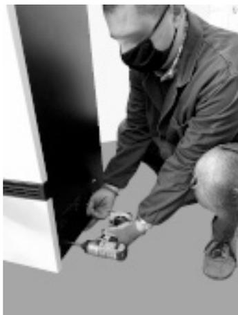
*Fig. 67 - Extracción de los tornillos*
