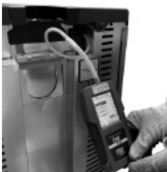
**Fig. 110 - Conexión del presostato digital (Atena - Duke)**
