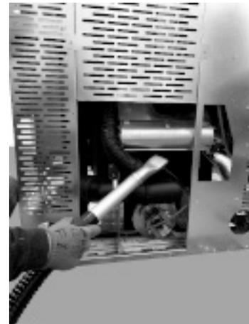
**Fig. 132 - Limpieza ventilador ambiente**
