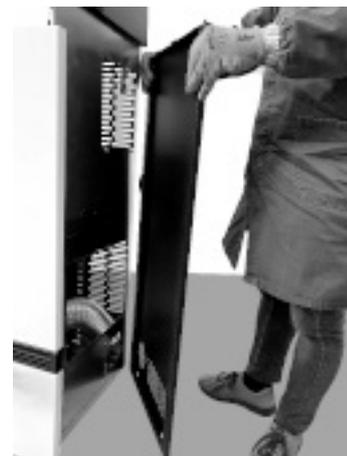
*Fig. 68 - Desmontaje de la pared*
