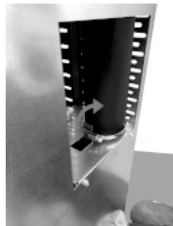
**Fig. 106 - Bloquear el tubo de conducción**
