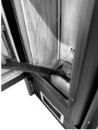
Fig. 35 - Limpieza alojamiento brasero
