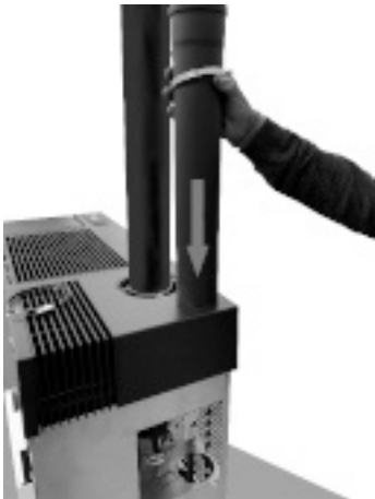
Fig. 102 - Das Kanalisationsrohr einführen
