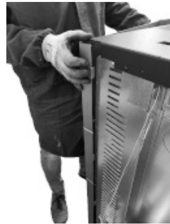
Fig. 28 - Die Seitenwand abnehmen
