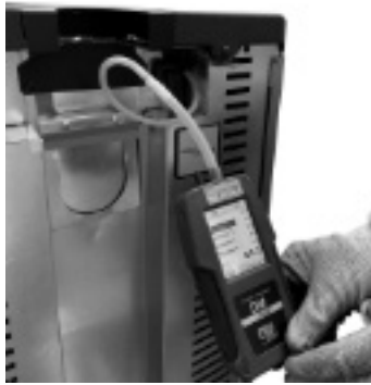
Fig. 108 - Anschluss des Digitaldruckwächters (Atena - Duke)
