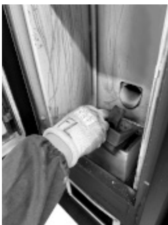
Fig. 111 - Remove the burning pot
