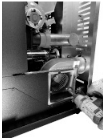
Fig. 81 - Remove fan screws
