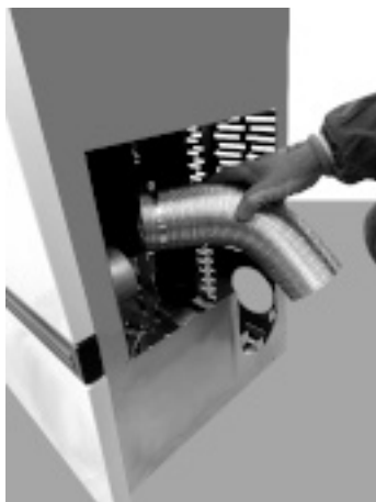
Fig. 105 - Enlever le tuyau flexible
