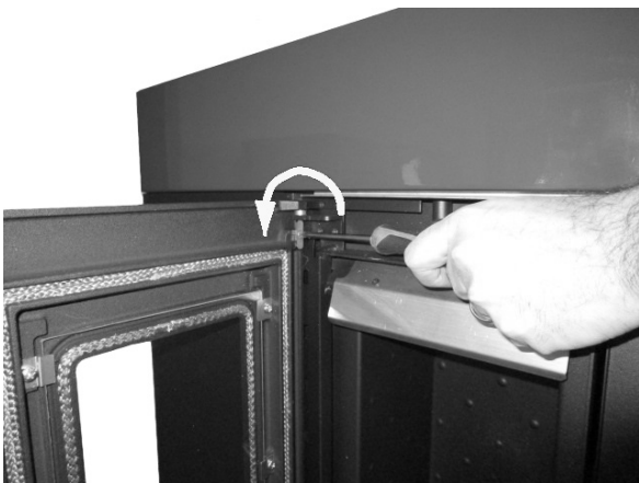
Fig. 28 - Retrait des vis
