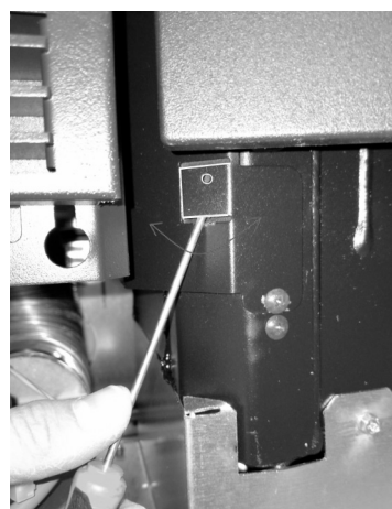
Fig. 58 - Soulever les ailettes 2
