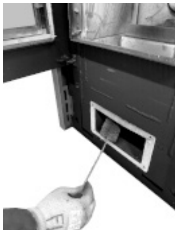
Fig. 122 - Nettoyer avec un goupillon
