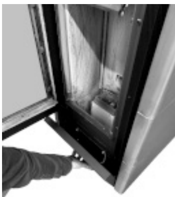
Fig. 41 - Enlever les panneaux avant.
