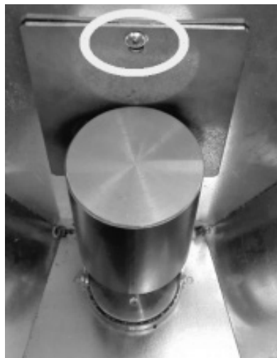
Fig. 141 - Retrait des vis
