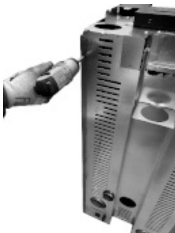
Fig. 38 - Retirer les vis
