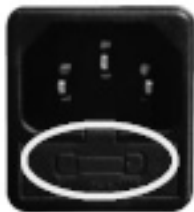
Fig. 78 - Sportellino con i fusibili da rimuovere
