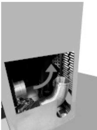
*Fig. 100 - Ruotare il tubo flessibile*
