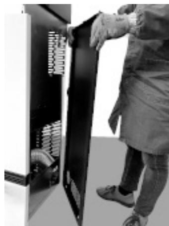
**Fig. 66 - Rimozione fianco**
