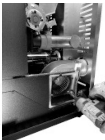
**Fig. 81 - Rimuovere viti ventilatore**
