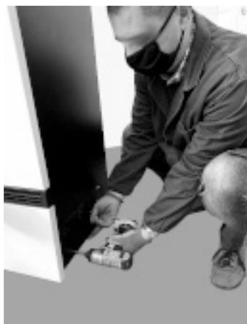
**Fig. 65 - Rimozione viti**
