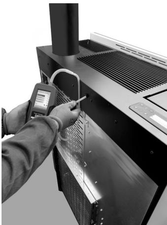
Fig. 109 - Collegamento pressostato digitale (Mithos)
