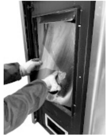
**Fig. 122 - Rimuovere la schiena del focolare**
