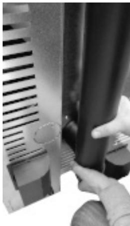
Fig. 74 - Innestare tubo d.80 mm
