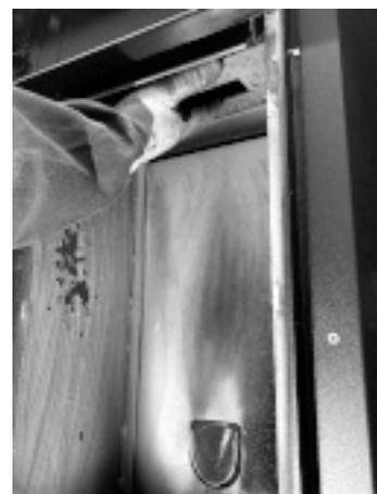
Fig. 119 - Rimuovere la testa del focolare 1
