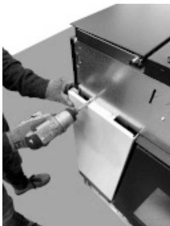
**Fig. 39 - Fissare pannelli laterali**
