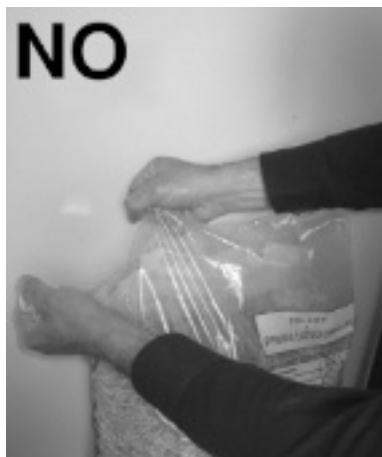
Fig. 24 - Apertura errata del sacco di pellet
