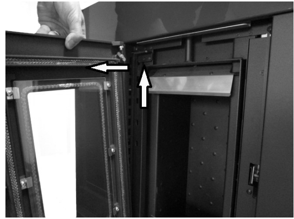
Fig. 36 - Verwijdering van de deur
