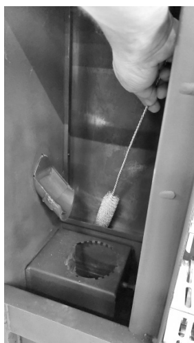
Fig. 69 - Reinig met pijpenwisser
