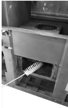
Fig. 63 - Reinig met pijpenwisser
