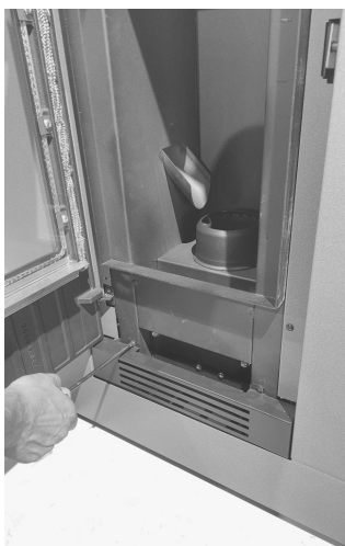
Fig. 60 - Verwijder het LUCE-masker
