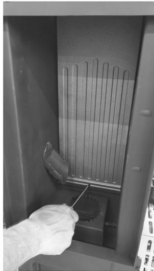
**Fig. 69 - Retire la parte trasera del hogar 1**
