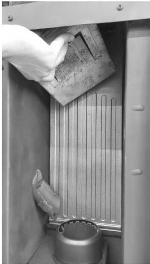
**Fig. 68 - Rimuovere la testa del focolare 1**
