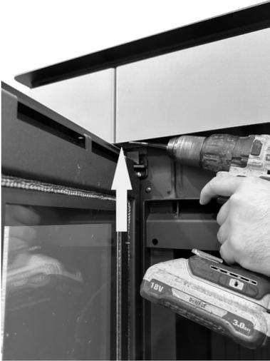
Fig. 34 - Retire el tornillo de seguridad
