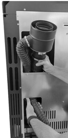
Fig. 48 - Acoplamiento del tubo d. 80 mm
