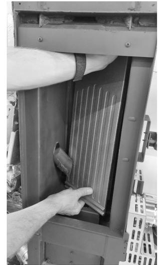
**Fig. 70 - Retire la parte trasera del hogar 2**
