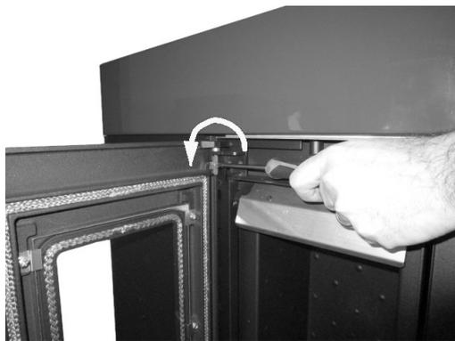
Fig. 37 - Extracción de los tornillos
