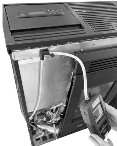
Fig. 59 - Conexión del presostato digital
