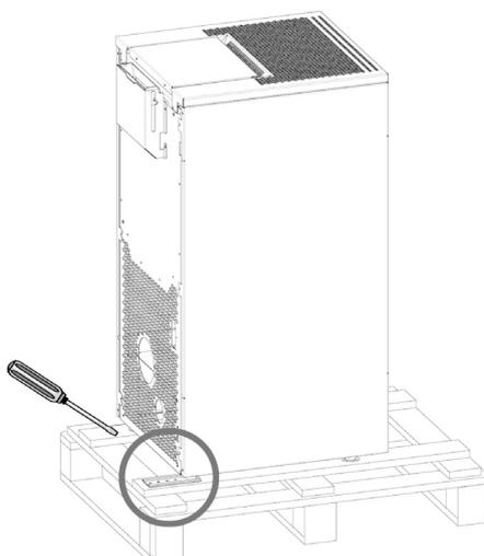
*Fig. 1 - Extracción de las abrazaderas*
