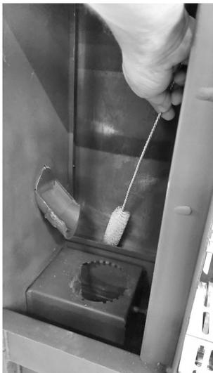
**Fig. 69 - Mit einer Rohrreinigungsbürste reinigen**
