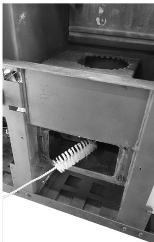
**Fig. 63 - Mit einer Rohrreinigungsbürste reinigen**
