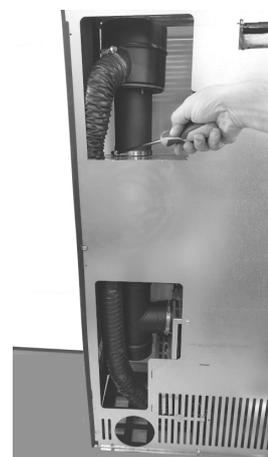
**Fig. 47 - Mit Schelle sichern**
