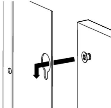
**Fig. 25 - Details der Kupplung**
