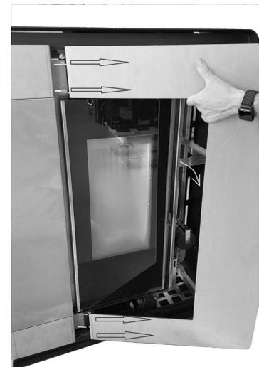
*Fig. 34 - Entfernen des Rahmens*
