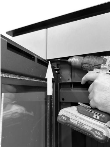
*Fig. 32 - Entfernen Sie die Sicherheitsschraube*
