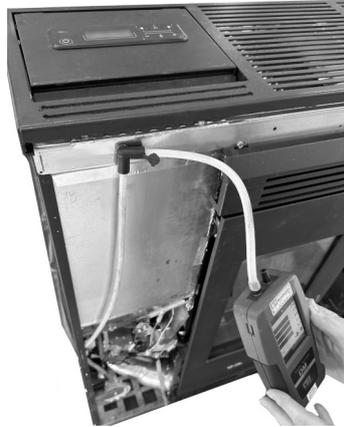
**Fig. 57 - Anschluss für digitalen Druckschalter**
