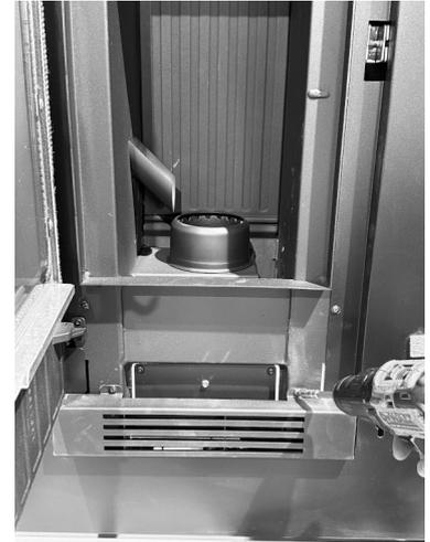
**Fig. 23 - Schrauben Sie die Maske**
