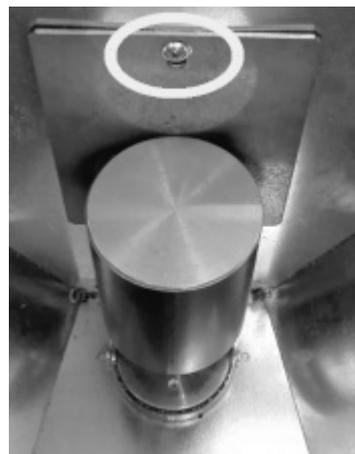
*Fig. 75 - Entfernen der Schraube*
