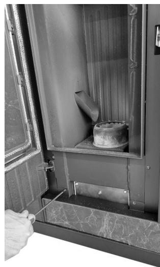
**Fig. 61 - Entfernen Sie die ARCO Maske**
