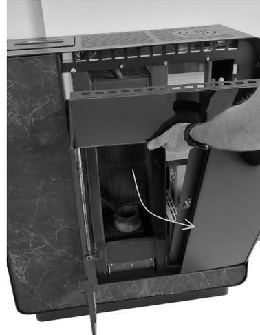
*Fig. 31 - Entfernen des Rahmens*
