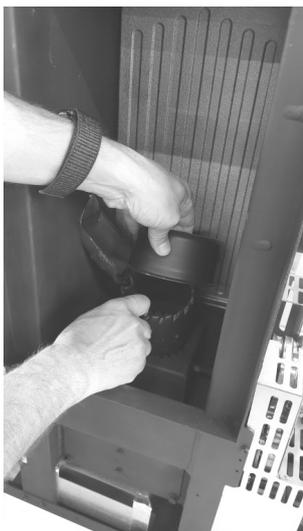
**Fig. 58 - Die Brennschale entfernen**
