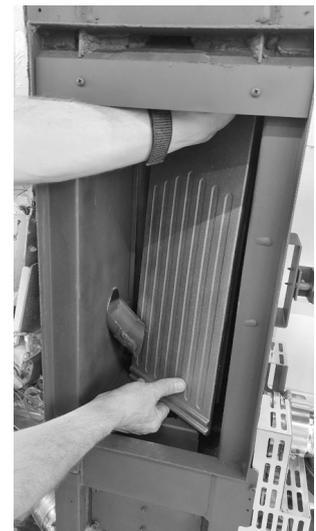
Fig. 68 - Entfernen Sie die Rückseite des Herdes 2
