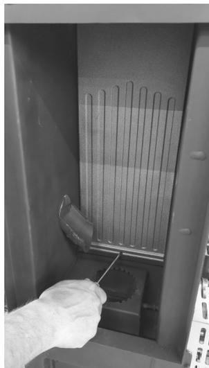
Fig. 67 - Entfernen Sie die Rückseite des Herdes 1
