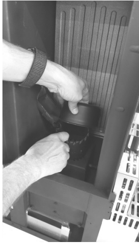
Fig. 58 - Remove the burning pot
