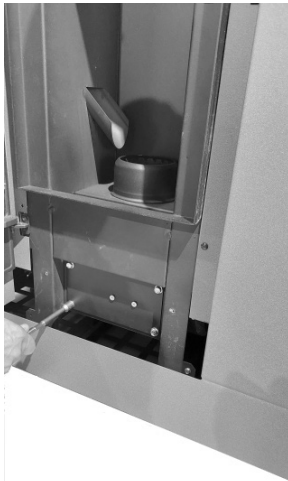
Fig. 71 - Remove the cap
