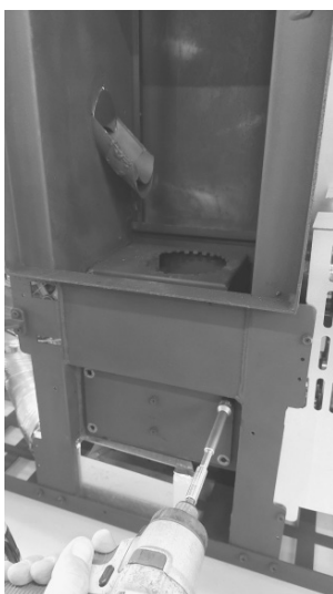
Fig. 62 - Remove the cap
