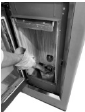
Fig. 33 - Nettoyage l'espace du brasero
