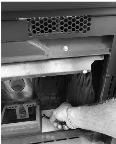
Fig. 24 - Verwijder de schroeven
