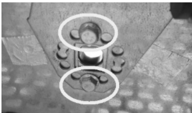
Fig. 32 - Verwijder de schroeven
