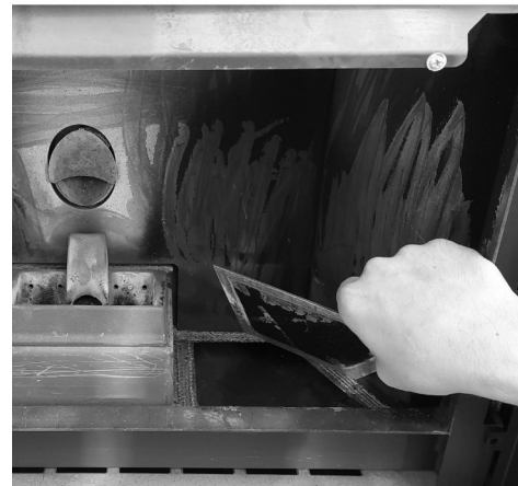
Fig. 25 - Verwijder de inspectiedop
