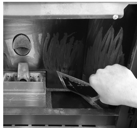
Fig. 27 - Retire la tapa de inspección
