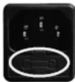
Fig. 33 - Ventanilla con los fusibles de remover
