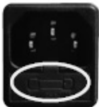
Fig. 31 - Abdeckklappe mit Sicherungen, die ausgewechselt werden müssen
