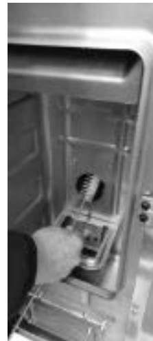
Fig. 35 - Reinigung mit Flaschenbürste
