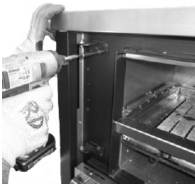
Fig. 23 - Desmontaje de los soportes
