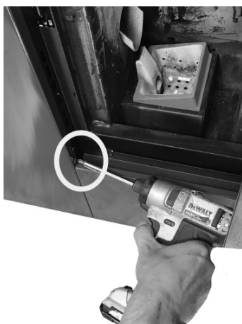
Fig. 44 - Extracción de los tornillos 1
