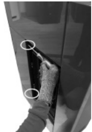
Fig. 27 - Fijación de los tornillos
