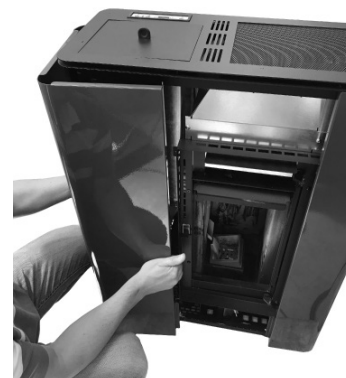
Fig. 49 - Extracción del panel
