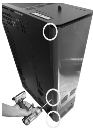
Fig. 48 - Extracción de los tornillos 4
