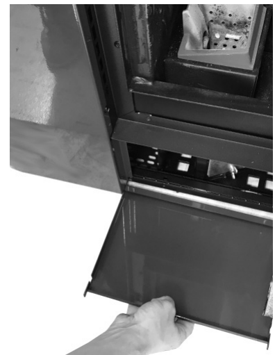
Fig. 44 - Ausbau der Einsätze
