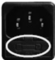
Fig. 75 - Abdeckklappe mit Sicherungen, die ausgewechselt werden müssen
