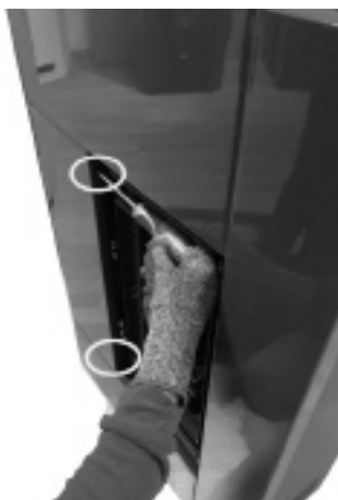
Fig. 49 - Retirer les vis.
