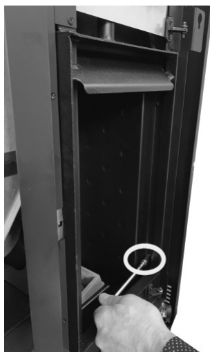
Fig. 78 - Retirer la vis 1
