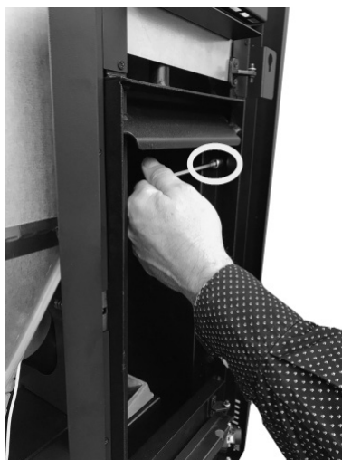
Fig. 79 - Retirer la vis 2
