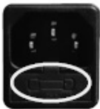
Fig. 84 - Hublot avec les fusibles à enlever
