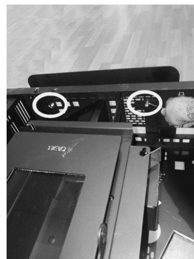
Fig. 64 - Bloquer les vis
