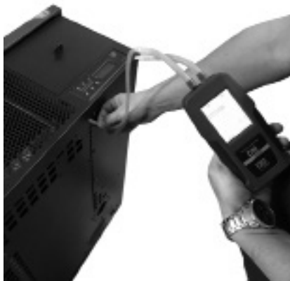
Fig. 74 - Raccordement du pressostat numérique
