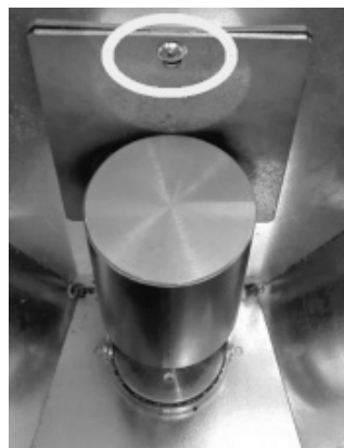
Fig. 86 - Retrait des vis
