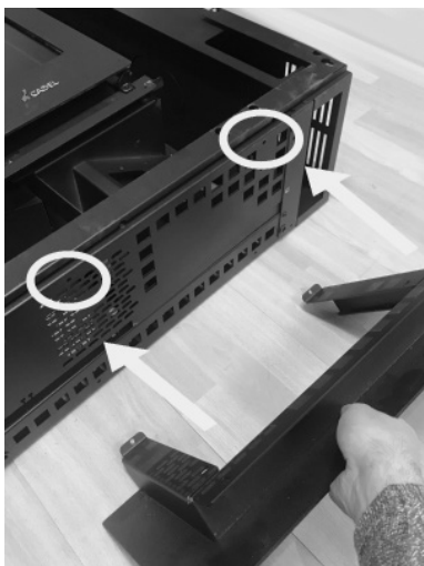
Fig. 62 - Mettre le piédestal en place
