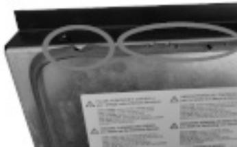
Fig. 23 - Junta deteriorada
