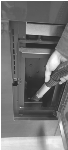
Fig. 39 - Nettoyage l'espace du brasero
