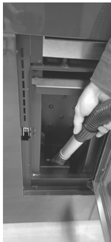
Fig. 35 - Limpieza alojamiento brasero
