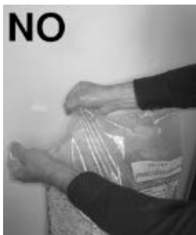
Fig. 24 - Ouverture incorrecte du sac des granulés
