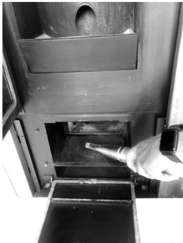
Fig. 86 - Aspire las cenizas
