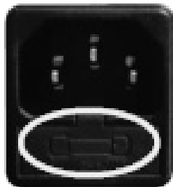
Fig. 97 - Ventanilla con los fusibles de remover
