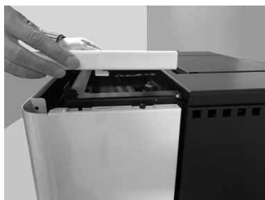
Fig. 53 - Colocación de la parte superior
