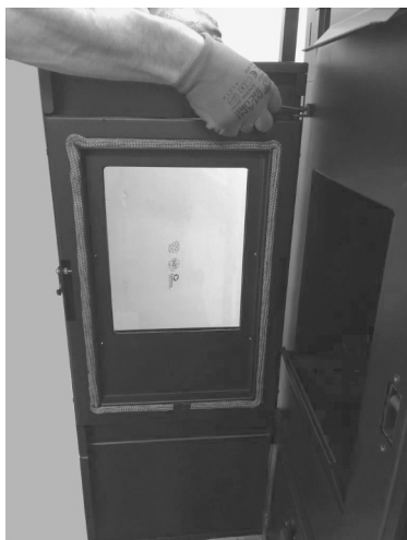
Fig. 21 - Extracción de los tornillos
