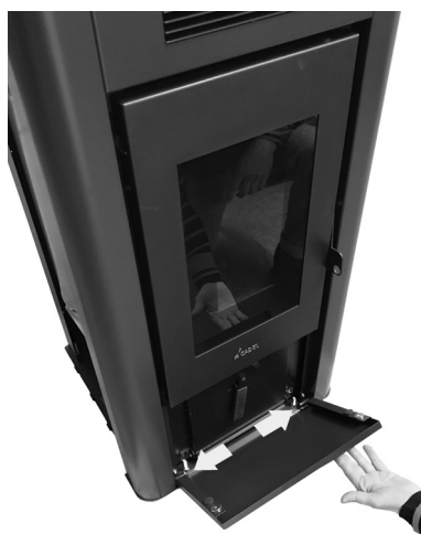
Fig. 27 - Inserción de la puerta inferior
