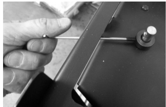
Fig. 91 - Schraube mit 2,5-mm-Schraubenschlüssel herausdrehen
