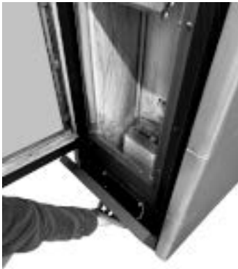
Fig. 32 - Verwijder de voorpanelen
