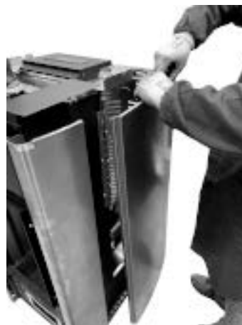
Fig. 30 - Verwijder de zijpanelen
