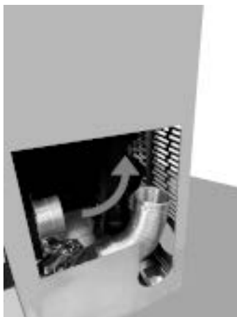
Fig. 97 - Draai de flexibele buis
