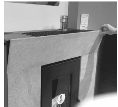
Fig. 62 - Koppel alle stenen vast
