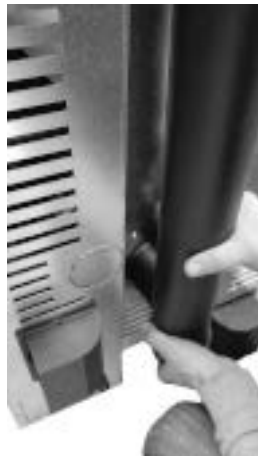
Fig. 74 - Koppel de buis met diameter 80 mm
