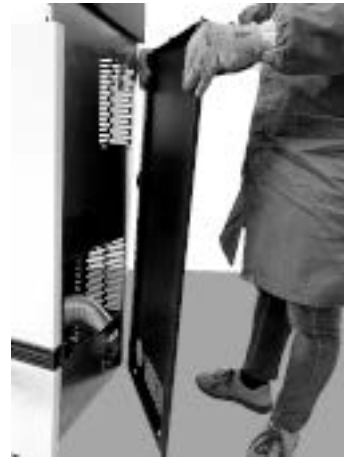
Fig. 66 - Verwijdering van het zijpaneel
