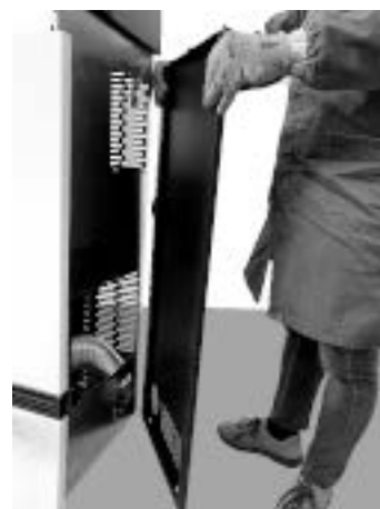
Fig. 63 - Desmontaje de la pared
