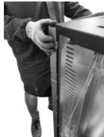
Fig. 25 - Retire las paredes laterales
