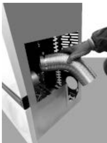
Fig. 93 - Den Schlauch entfernen
