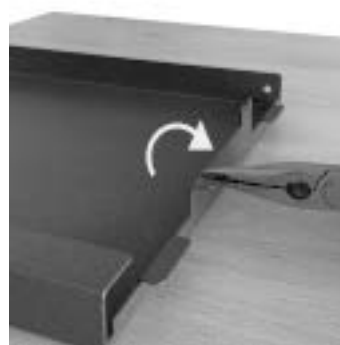
Fig. 35 - Pliegue las lengüetas hacia afuera
