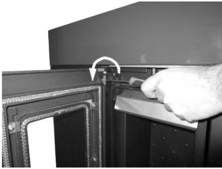
Fig. 16 - Extracción de los tornillos
