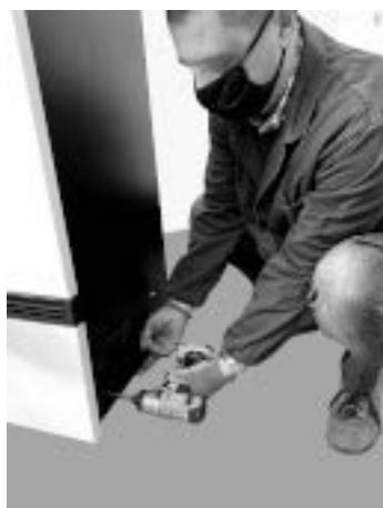
Fig. 62 - Extracción de los tornillos
