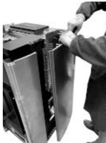
Fig. 27 - Retire las paredes laterales
