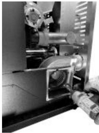
Fig. 79 - Extraiga los tornillos del ventilador
