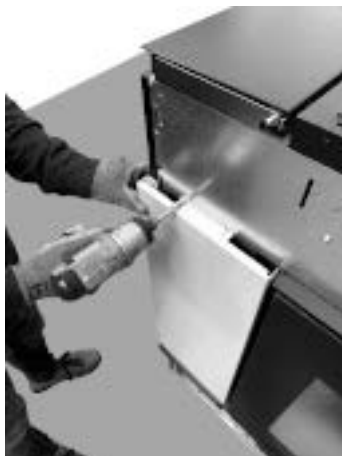
Fig. 36 - Fije los paneles laterales
