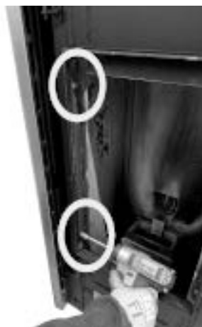
Fig. 116 - Extraiga los tornillos hexagonales
