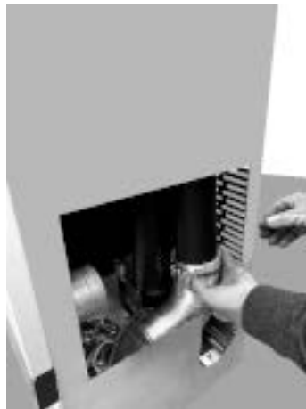
Fig. 99 - Die Rohre anschließen
