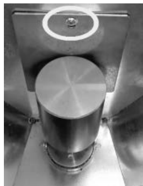
Fig. 131 - Retirada del tornillo
