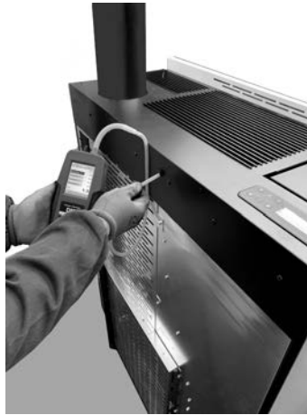
Fig. 107 - Conexión del presostato digital (Mithos 3 Plus12/14)
