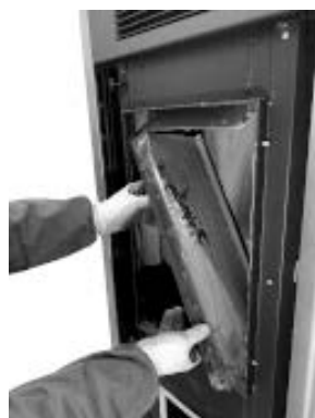
Fig. 119 - Retire las paredes laterales
