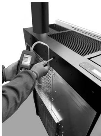
**Fig. 110 - Anschluss des Digitaldruckwächters (Mithos<sup>3</sup> Plus12/14)**
