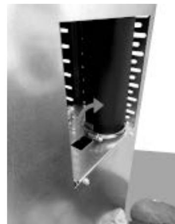
*Fig. 103 - Das Kanalisationsrohr festspannen*
