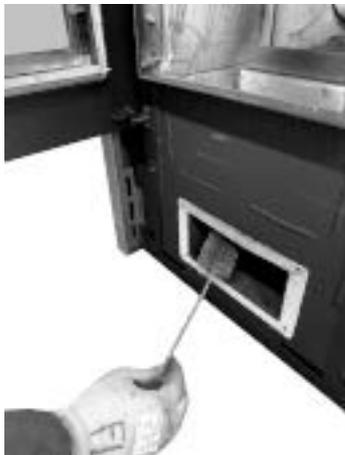
**Fig. 115 - Mit einer Rohrreinigungsbürste reinigen**
