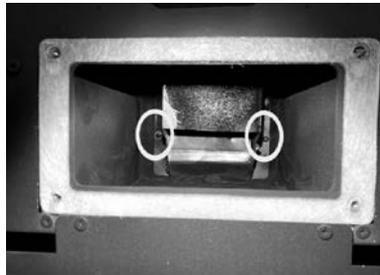
*Fig. 127 - Die Schrauben lösen*
