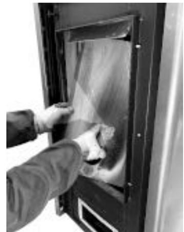
*Fig. 123 - Die Rückseite des Feuerraums entfernen*
