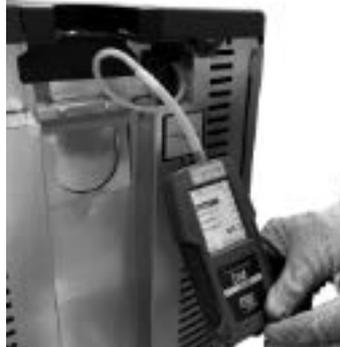
**Fig. 109 - Anschluss des Digitaldruckwächters (Atena<sup>3</sup> Plus12/14 - Duke 12/14 At - Saba 12/14)**
