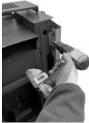
**Fig. 33 - Die Schrauben entfernen**
