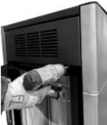
*Fig. 24 - Die Schrauben entfernen*
