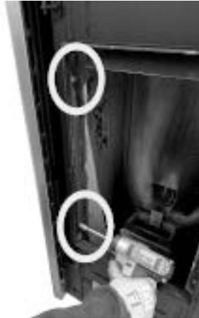
*Fig. 119 - Die Sechskantschrauben entfernen*
