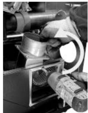
*Fig. 83 - Den Ventilator drehen*
