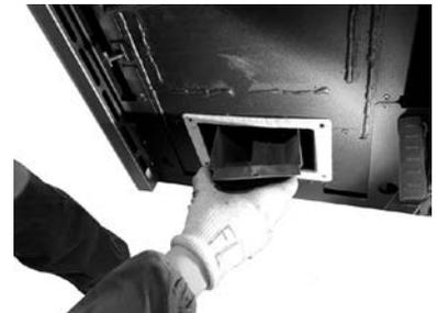
*Fig. 128 - Rauchabweiser entfernen*
