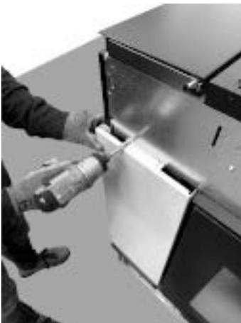
**Fig. 39 - Befestigung der Seitenwände**
