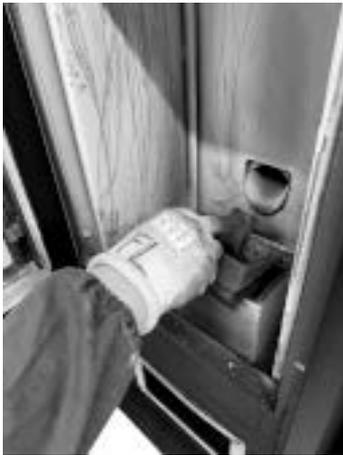
**Fig. 112 - Die Brennschale entfernen**
