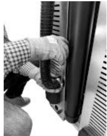
Fig. 76 - Rohr der Heizluft einstecken
