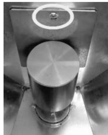
**Fig. 134 - Entfernen der Schraube**
