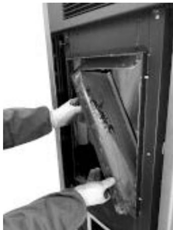
*Fig. 122 - Die Seitenwände entfernen*
