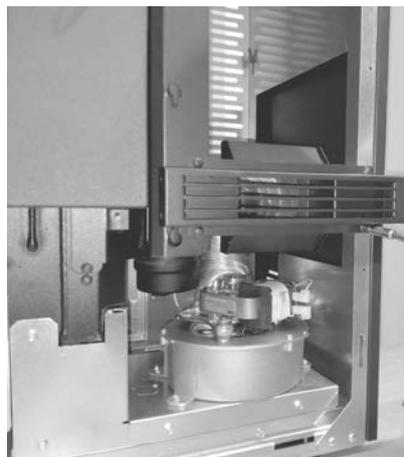
*Fig. 50 - Luftöffnungen lockern*
