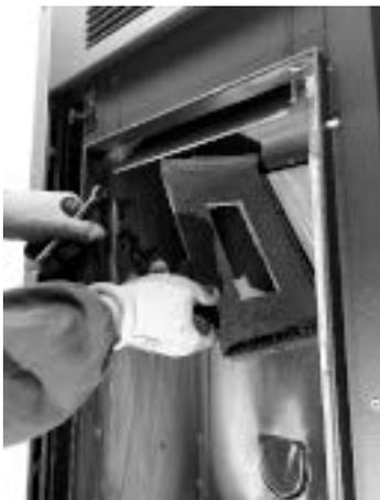
*Fig. 121 - Die Stirnseite des Feuerraums 2 entfernen*
