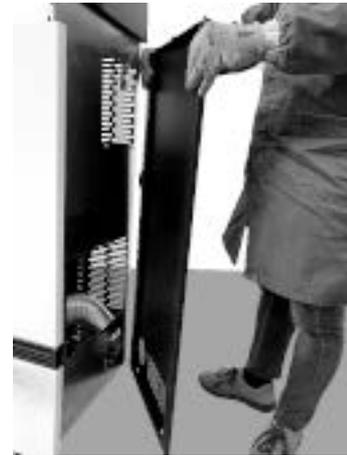
*Fig. 66 - Abnehmen der Seitenwand*
