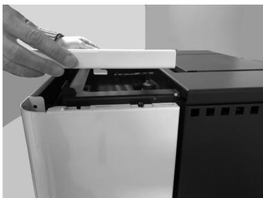
Fig. 25 - Colocación de la parte superior
