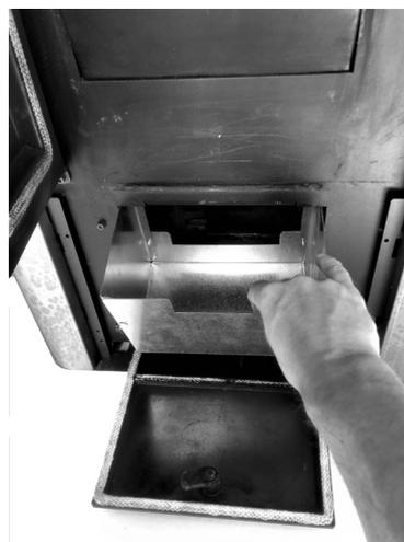
Fig. 59 - Retire la tapa de inspección
