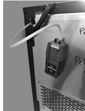
Fig. 35 - Conexión del presostato digital
