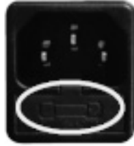
Fig. 69 - Abdeckklappe mit Sicherungen, die ausgewechselt werden müssen
