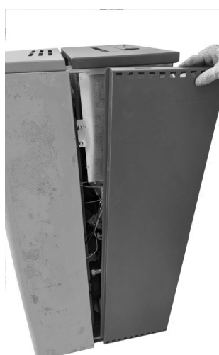
Fig. 48 - Verwijder de zijkant
