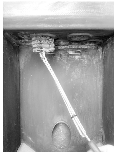
Fig. 60 - Reinig met pijpenwisser
